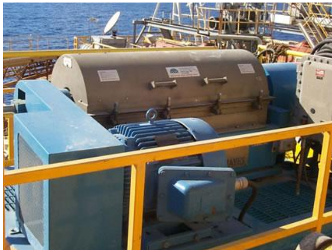
Centrifuga që përdoret për të veçuar baltën e shpimit nga mbetjet e ngurta
