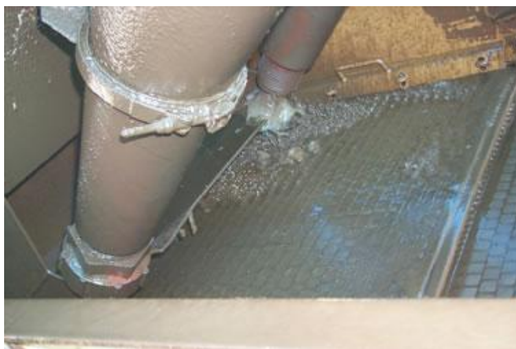
‘Shale shaker’ (Sita (Vibruesi) I shistit Argjilor)
